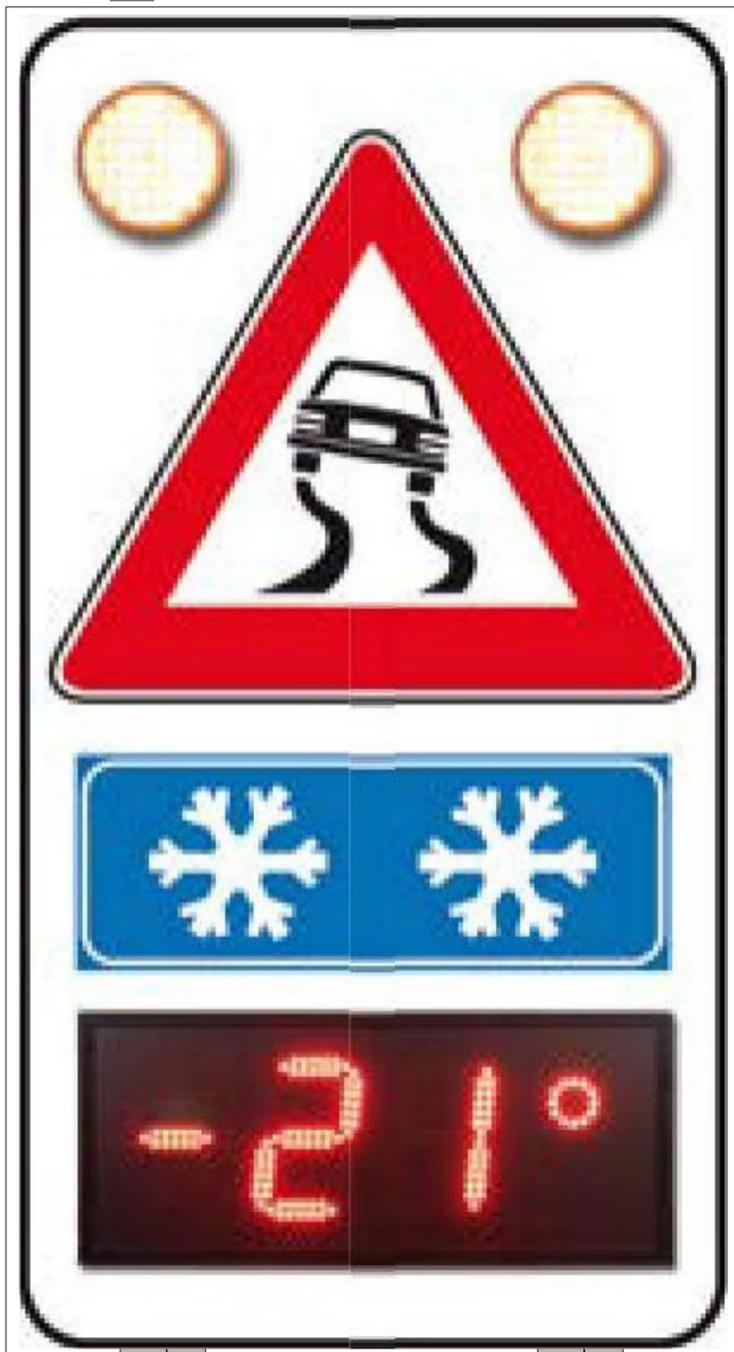
Targa da cm 100x180 o 200 con doppi lampeggianti a led diam mm 200 e display con temperatura. Il sistema entra in funzione quando la temperatura scende al di sotto dei 3° C
