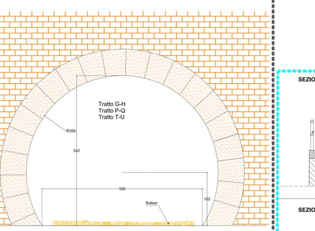
SEZIONE PISTA CICLABILE - STATO DI PROGETTO Scala 1:50
