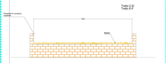
SEZIONE TIPOLOGICA 1 - PONTE IN MURATURA - STATO DI PROGETTO Scala 1:50
