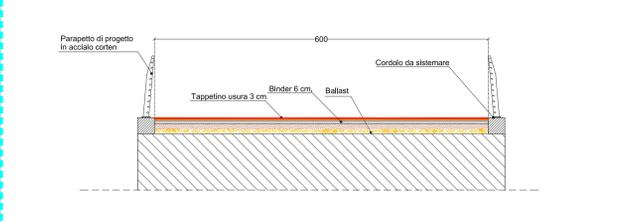
SEZIONE TIPOLOGICA GALLERIE IN MURATURA - STATO DI FATTO Scala 1:50
