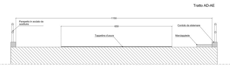
SEZIONE TIPOLOGICA 2 - PONTE IN CEMENTO ARMATO - STATO DI PROGETTO Scala 1:50
