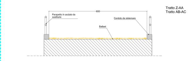
SEZIONE TIPOLOGICA 2 - PONTE IN CEMENTO ARMATO - STATO DI PROGETTO Scala 1:50
