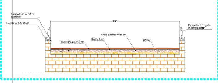
SEZIONE TIPOLOGICA 2 - PONTE IN CEMENTO ARMATO - STATO DI FATTO Scala 1:50
