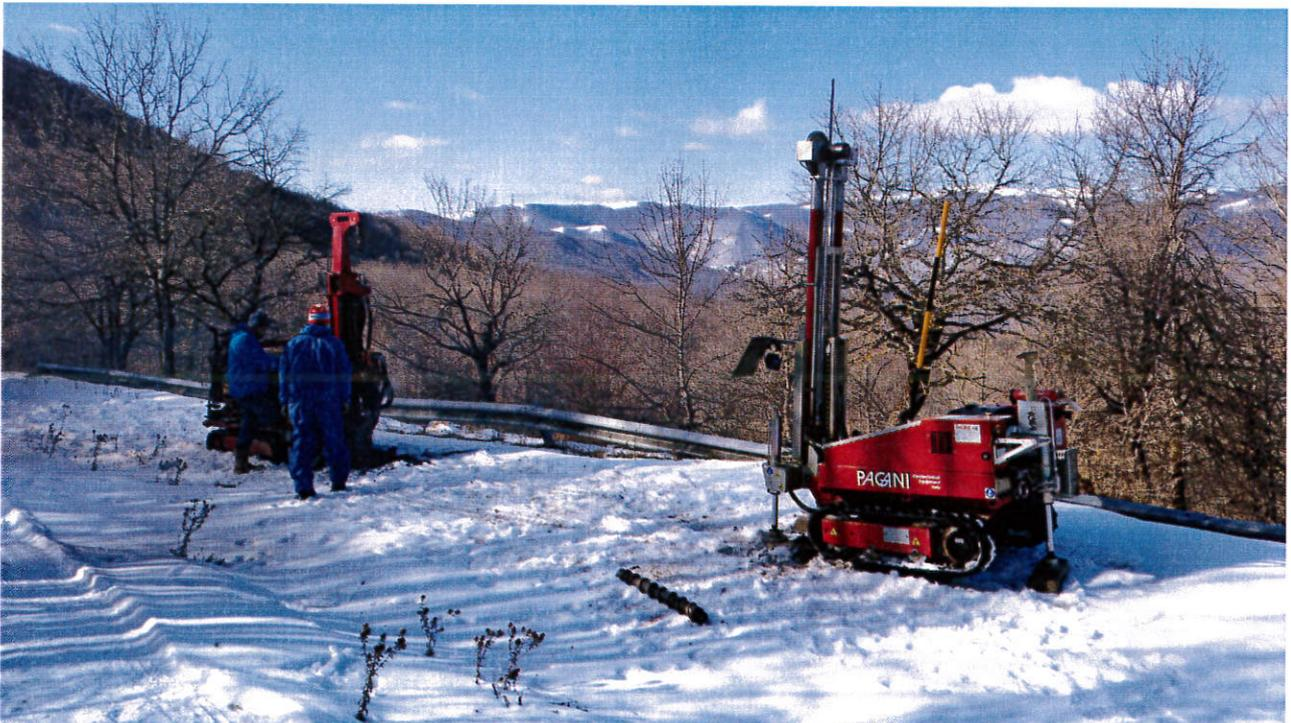
**Foto n°4** – Particolare postazione Trivella Idraulica F.lli Mori, sondaggio S2, e Penetrometro Pagani TG63-100KN. Prova DPSH P2.
