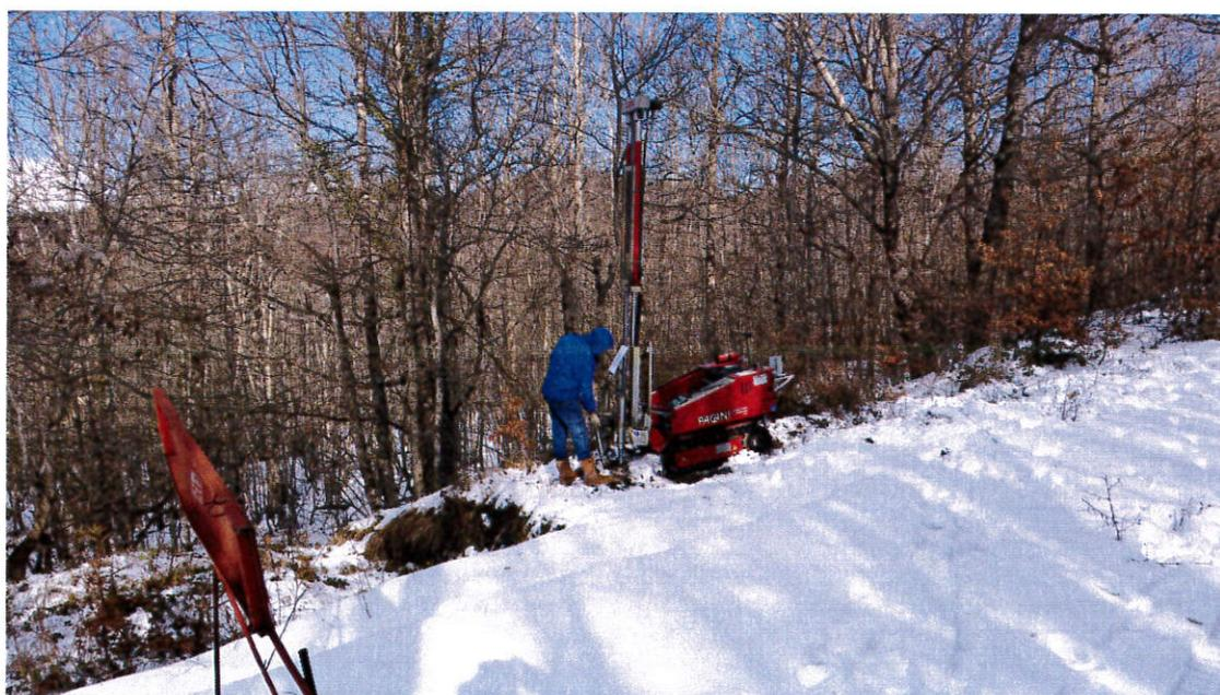
**Foto n°2** – Particolare postazione Penetrometro Pagani TG63-100KN. Prova DPSH **P1**.
