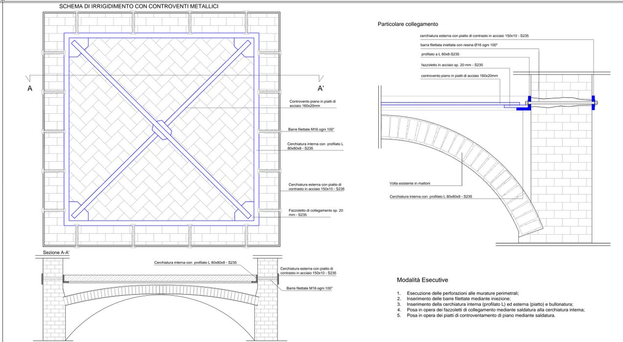
**Intervento 5: Consolidamento VOLTE di sottotetto con FRP e irrigidimento con elementi metallici**
