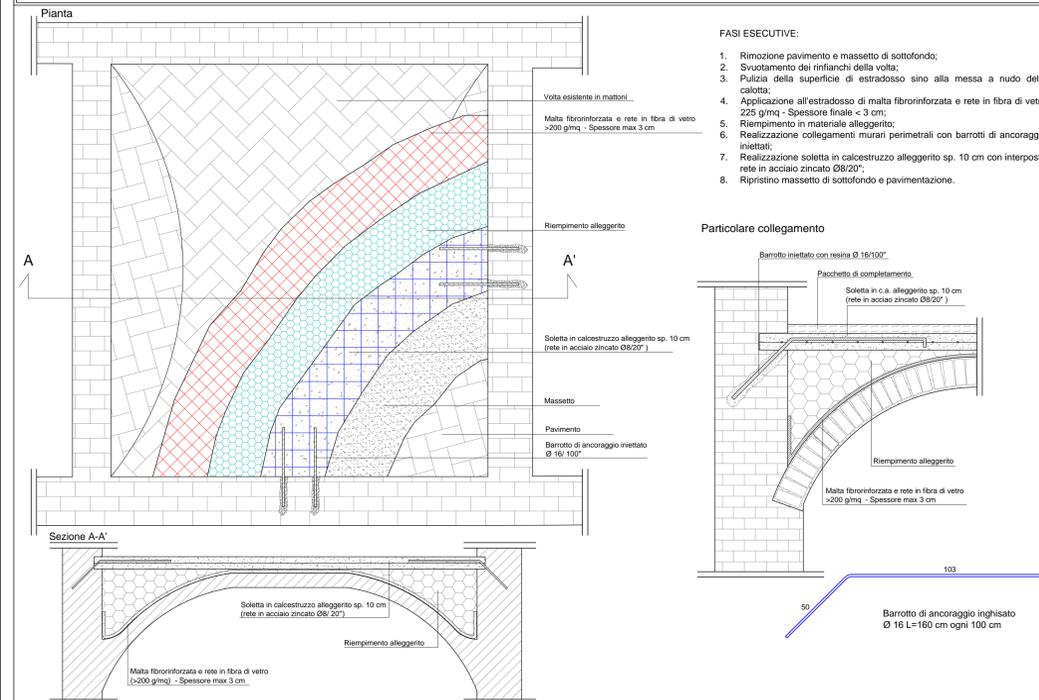
**Intervento 4 : Consolidamento di solaio in putrelle con soletta di irrigidimento in c.a. alleggerito**
