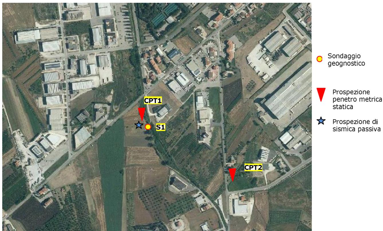
Il rilevamento geologico, i dati provenienti dalla bibliografia, le stratigrafie desunte dal sondaggio geognostico e dalle prospezioni penetrometriche realizzate nell'area sedime dell'opera, hanno permesso di ricostruire la successione stratigrafica dei terreni presenti nel sottosuolo del sito.
