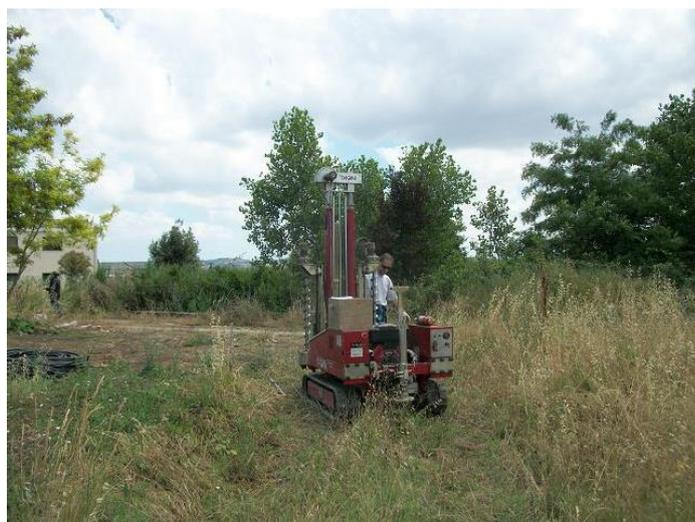
Al fine di valutare la locale situazione stratigrafica, le caratteristiche fisico-meccaniche dei terreni presenti, a completamento del rilievo geologico e geomorfologico di superficie, sono state realizzate n. 2 prospezioni penetrometriche statiche di tipo C.P.T. e n. 1 sondaggio geognostico a carotaggio continuo. Le prospezioni penetrometriche statiche hanno raggiunto la profondità massima di 10 m dal p.c., mentre il sondaggio geognostico ha raggiunto la profondità di 15 m dal p.c.
